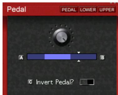
Mit den Drehknöpfen A und B kann der Minimum- und der Maximumwert eingestellt werden. Der Pfeil am Balken zeigt die aktuelle Position des Pedals an. Mit dem Drehknopf C kann die Funktion des Pedals invertiert werden.
