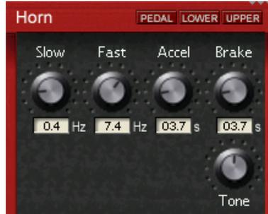
Hier können Sie diverse Parameter der Rotor-Emulation einstellen. Viele Rotor-Anlagen haben einen Lautsprecher für Bässe (Bass) und ein Horn für die Höhen (Treble), die unterschiedlich rotieren und deren Verhalten bei der B4000+ getrennt geregelt werden kann.
