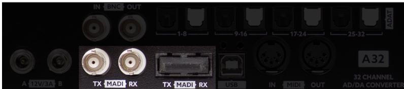
Die A32 erlaubt sowohl den Betrieb mit optischen Glasfaserkabeln (SC Anschluss) als auch mit Koaxialkabeln mit einem Wellenwiderstand 75 Ohm und BNC Steckern.
