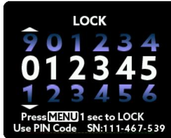
Nach Eingabe der korrekten PIN halten Sie die MENU Taste bitte eine Sekunde lang gedrückt. Das Gerät ist danach gesperrt.
