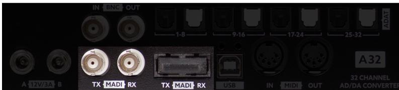
Die A32 DANTE erlaubt sowohl den Betrieb mit optischen Glasfaserkabeln (SC Anschluss) als auch mit Koaxialkabeln mit einem Wellenwiderstand 75 Ohm und BNC Steckern.
