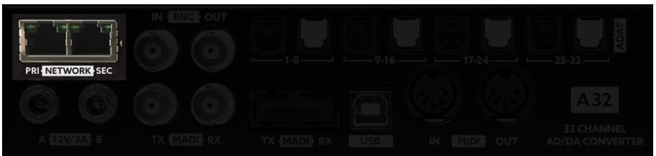
Der DANTE Anschluss wird einfach mit einem Gigabit (!) Netzwerkschwitch über Ethernetkabel (CAT5e oder besser) oder direkt mit einem Computer verbunden. Eine WLAN-Verbindung für Audio ist nicht möglich. Ein „crossed“ Ethernet Kabel ist nicht erforderlich. Bitte beachten Sie, dass beim Betrieb mehrerer A32 DANTE Geräte diese über Switches zu verbinden sind. Ein „Durchschleifen“ von Gerät A nach Gerät B ist nicht unterstützt.
